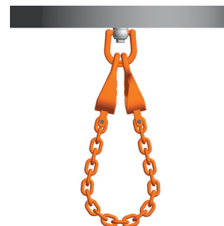
Bild 6: Korrekte Montage der Hülse
